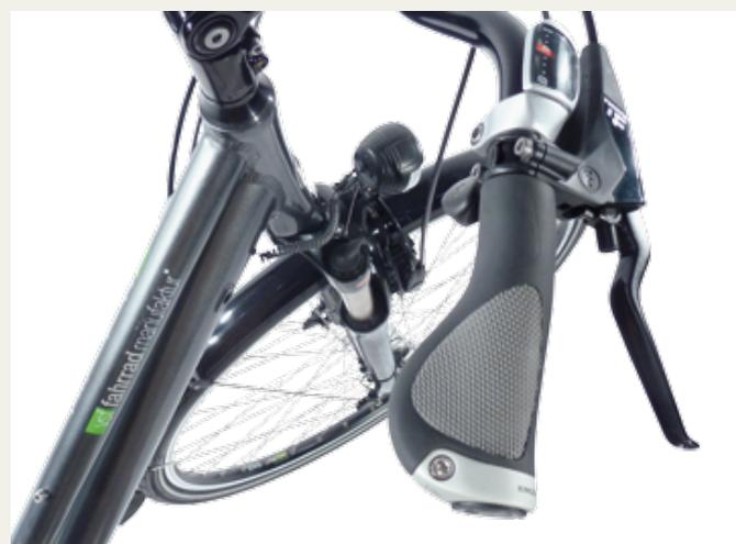
**LINKS** Der Gepäckträgerakku von Bosch sitzt etwas verloren zwischen den Gepäckträgerstreben. Er lässt sich aber leicht herausnehmen. · **RECHTS** Komfort auf ganzer Linie, ergonomische Lenkergriffe, Magura Hydraulik-Bremshebel und Shimano Schaltung sowie Bosch Bedieneinheit runden den Eindruck des Lenkers ab.
