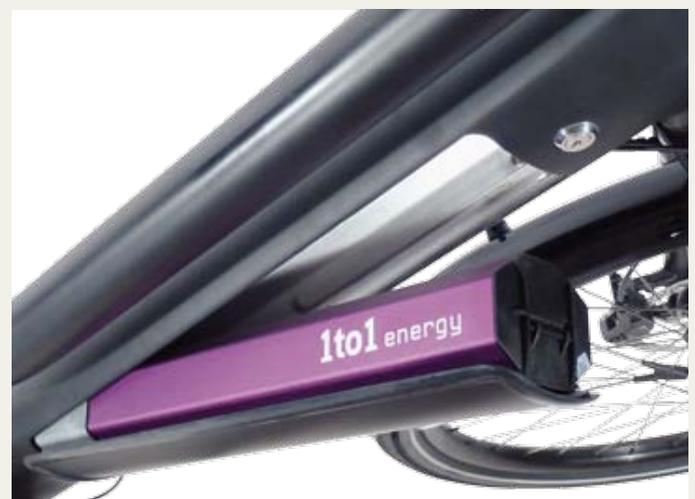
**LINKS** Der Motor des Stromer kräftig groß und schwarz von *UltraMotor*. *Shimano XT* Kettenschaltung und *TMM4* Kraftsensor im Ausfallende. · **RECHTS** Genial wie schon beim Vorjahresmodell die einfache und sichere Batterieaufbewahrung im Rahmen und die trotzdem kinderleichte Entnahme!
