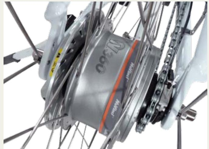
**LINKS** Das Pedelecs zu einer allgemeinen Erscheinung geworden sind, lässt sich auch daran ablesen, dass es nun auch schon spezielle Reifen für diese gibt! **RECHTS** Die NuVinci Nabenschaltung mit dem stufenlosen Planetenkegelgetriebe ermöglicht auch am Berg unter Last zu schalten – dies ist besonders bei Tretlagermotoren von Vorteil.
